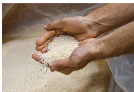
Aus diesem Granulat auf Pflanzen- und Gesteinsbasis werden die Arbotrade-Wuchshüllen hergestellt
