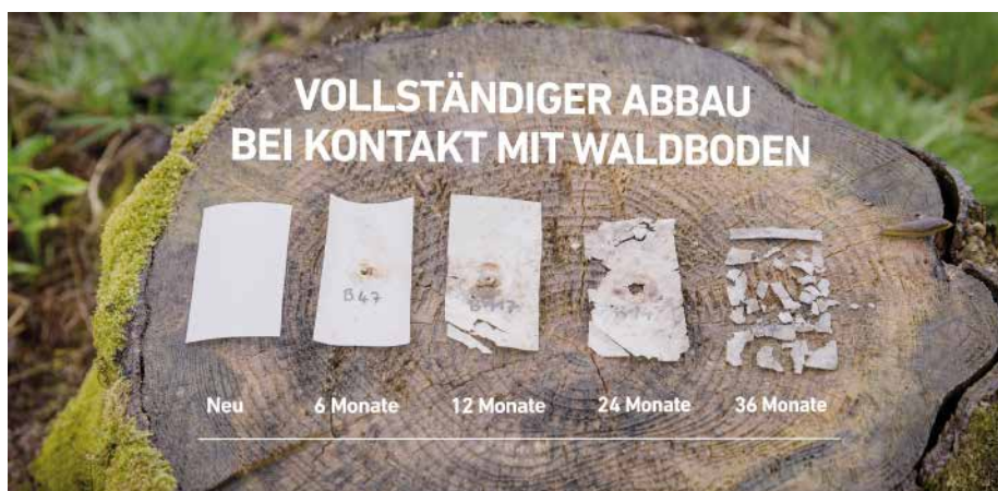
Nach drei Jahren mit Kontakt zum Waldboden ist das Material der Arbotrade-Hüllen weitgehend abgebaut
